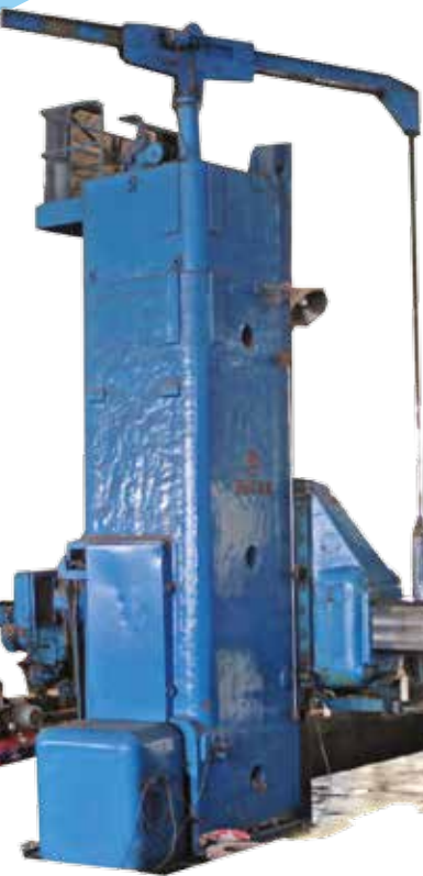
SKODA WD-200 X - 11000 Y - 2150 Z - 1600 Spindle DIA - 200
